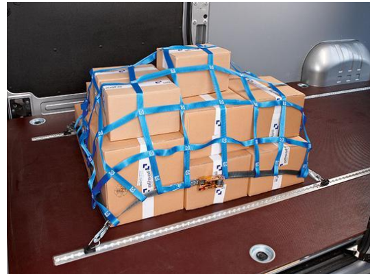
Abbildung 13: Netz an Schiene befestigt
